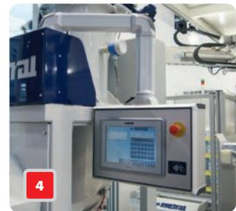
**1** In der Verpackungsmaschine Essegi F1000 sind zwei Dosierwaagen integriert. Jede von ihnen ist mit einer Wägesteuerung Data Pond 3F von B + L Industrial Measurements ausgerüstet. (Bilder: B + L)
