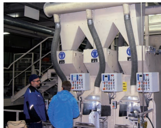
01 Die Klebsandsorten werden aus der zentralen Mischanlage kommandiert entweder als loses Schüttgut verladen oder den verschiedenen Packgruppen zugeführt
