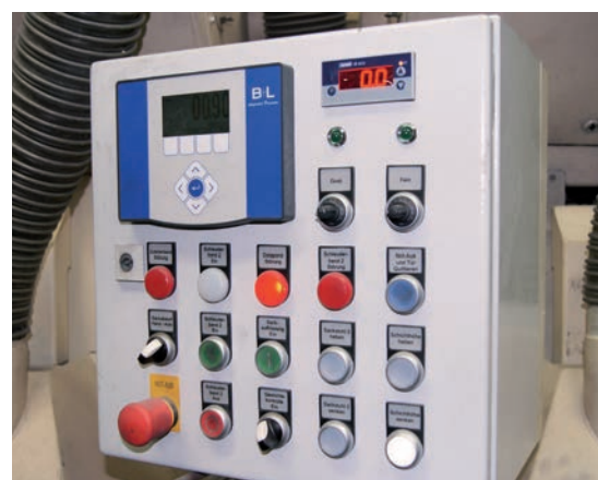
02 Das platzsparende Bedienpanel der Wägesteuerung überzeugt durch eine benutzerfreundliche Menüführung
